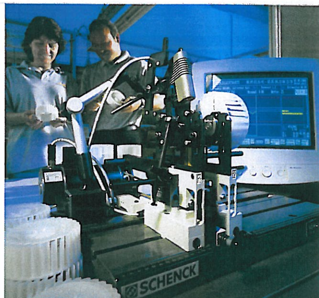
Um die Produktionsqualität zu sichern, misst PVS hergestellte Spritzgussteile nach (Fotos: PVS)
